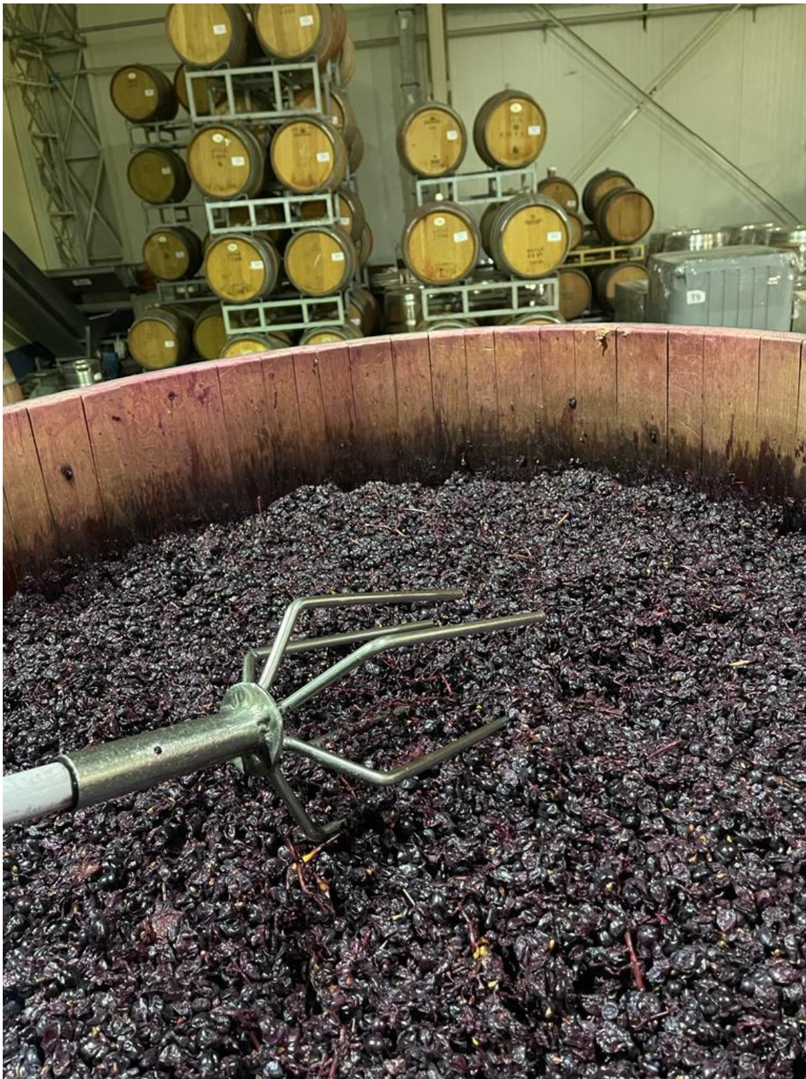
Figura 37. Remontaje con pisón.
