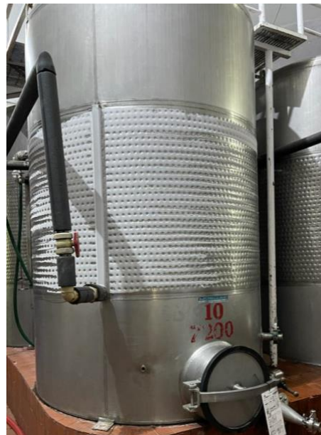
Figura 13. Cuba de acero inoxidable con el sistema frío encendido.
