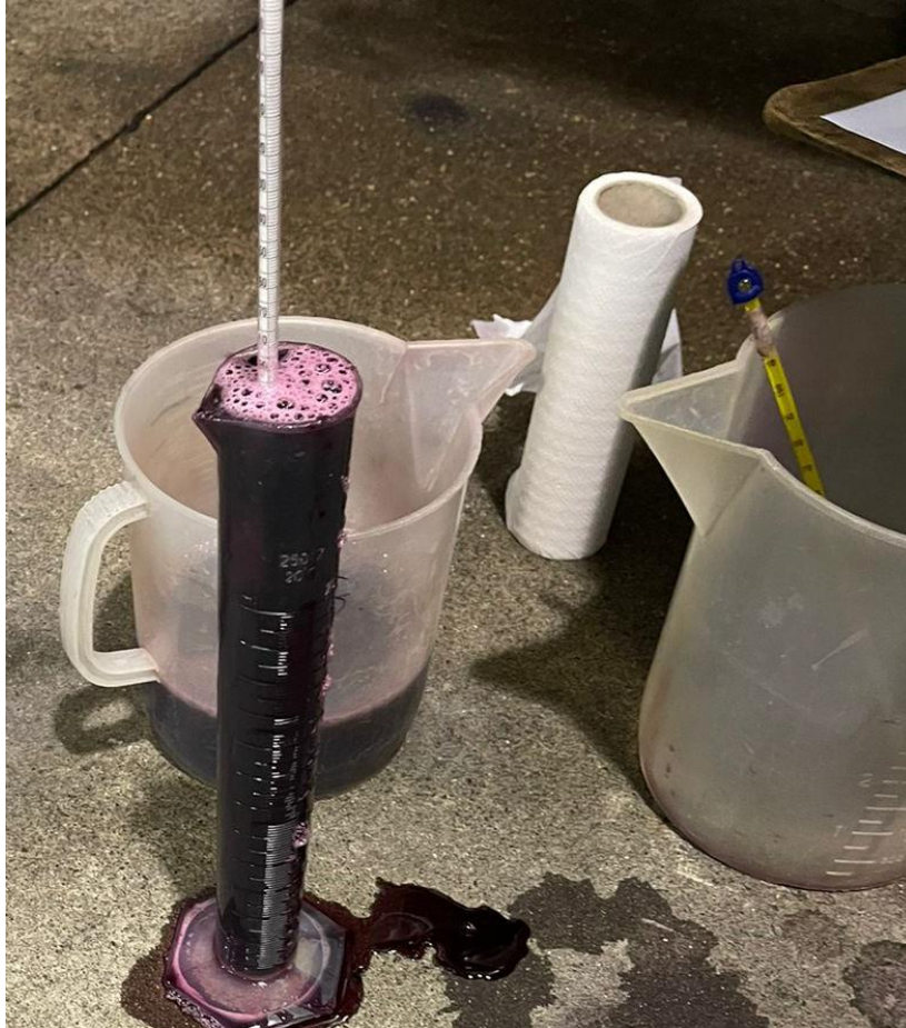
Figura 12. Medición de densidad en el mosto.
