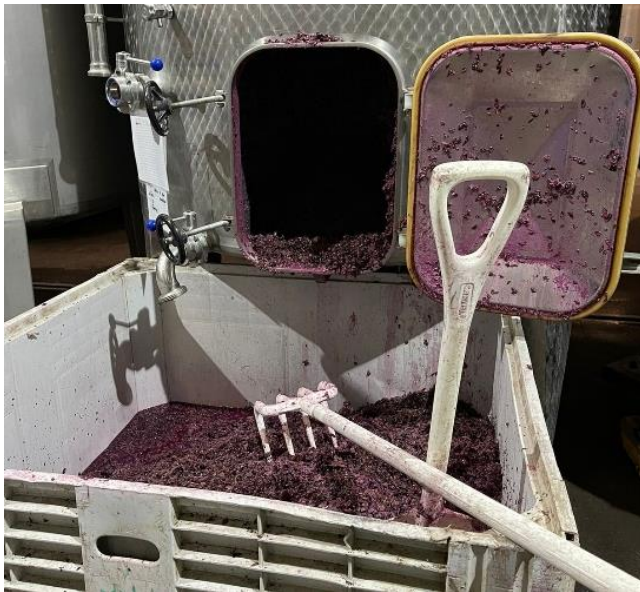
Figura 17. Descube de tanque
