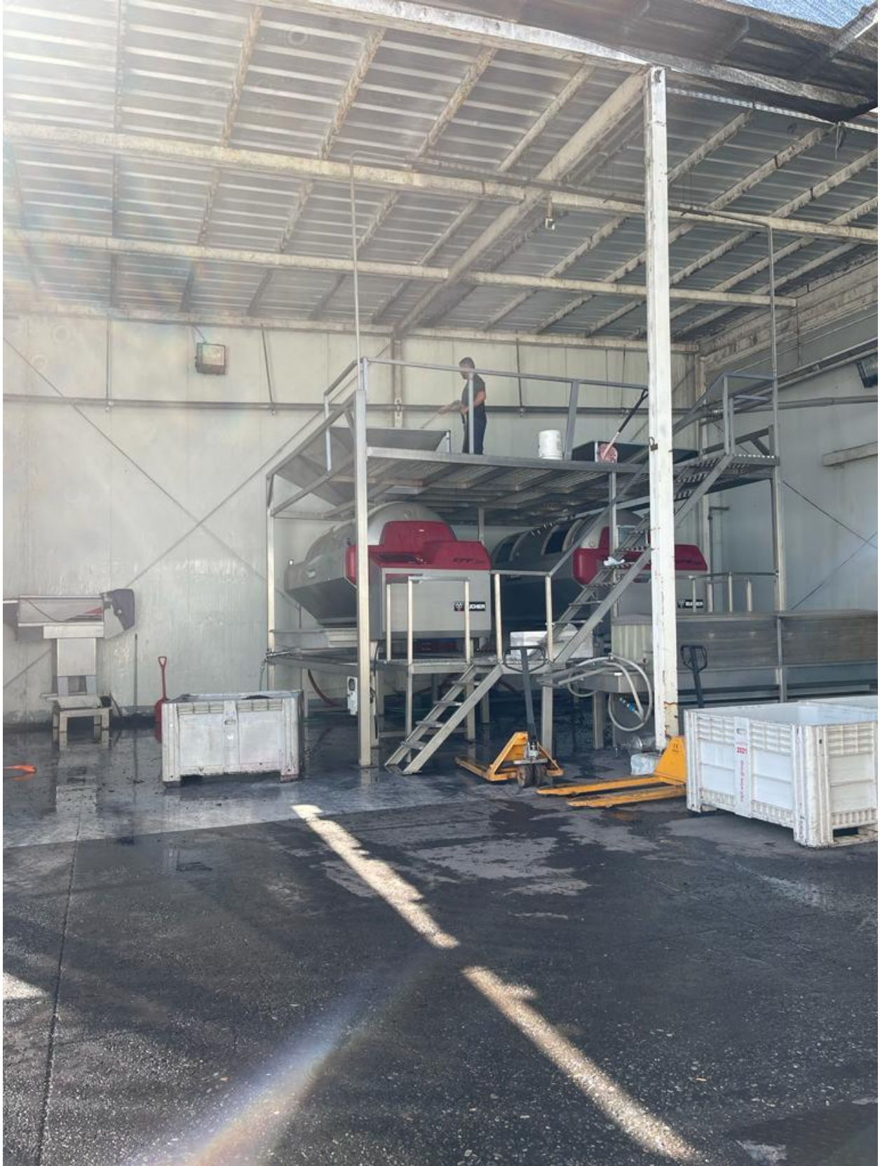
Figura 51. Lavado y sanitización de prensa neumática.
