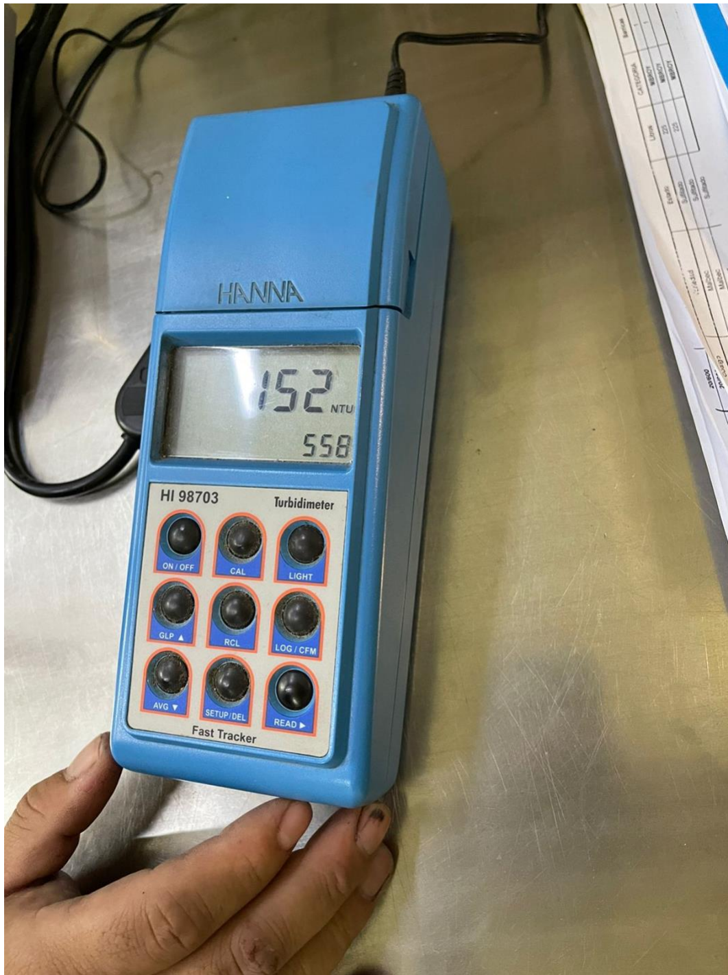
Figura 56. Aparato para medir el nivel de turbidez del vino.
